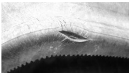
Fot. Uszkodzenie stopki.
